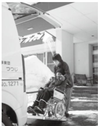
スロープは、電動ウインチを使って、スムーズに、安全に乗降できます。
